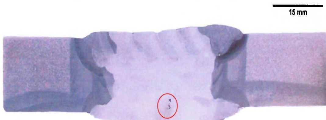
Figura 5.4 – Macrografia da amostra 4 soldada com o processo arame tubular autoprottegido localizado no patim do trilho. Círculo vermelho indica inclusão entre 1 e 2mm no metal de solda. Nital 10%.
